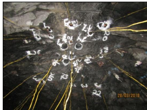
Figura 4. Slot carregado, pronto para iniciar a conexão de todos os furos a linha de iniciação.
